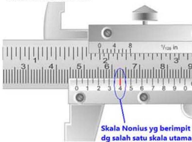
Mula mula perhatikan skala nonius yang berimpit dengan salah satu skala utama. Hitunglah berapa skala hingga ke angka nol. Pada gambar, skala nonius yang berimpit dengan skala utama adalah 4 skala. Artinya angka tersebut 0,4 mm. Selanjutnya
